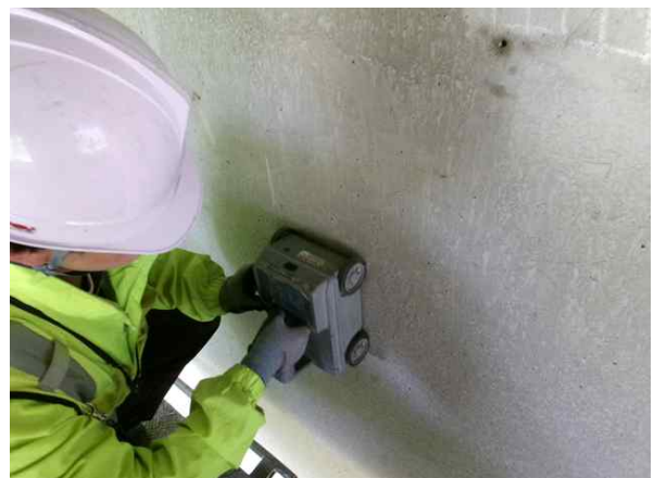
철근탐사 시험 현황
